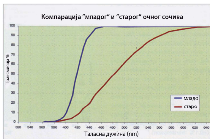
Слика 5 – Трансмисивност „младог“ и „старог“ сочива
